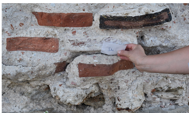
Сл. 3 Узорковање малтера током теренског истраживања (фото: фотодокументација пројекта MoDeCo2000, 2020)
